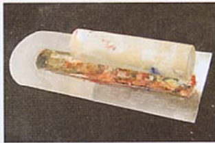
金鏝(土間鏝) 腰が柔らかく、仕上げでテクスチャを押さえるのに適している
