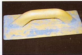
プラスチック鏝 面が大きく、力を均等に押し付けることができる
