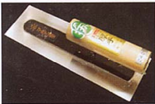
金鏝(角鏝) 硬い鏝で主に主材を塗布する。白い材料にはステンレス製がよい
