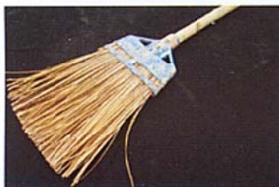
竹ぼうき 縦、横に動かしてテクスチャを付ける
