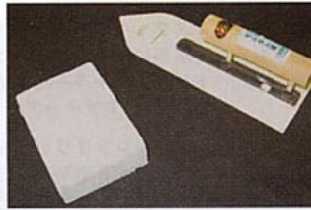
ウレタン鏝(右)、スタイロフォーム ウレタン鏝は裏に凹凸がある。骨材を転がしやすい
