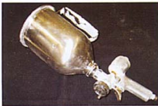
リシガン テクスチャごとに口径、圧力を守り、吹きムラがないようにする
