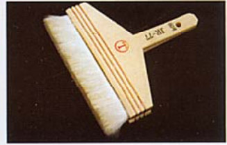
掃刷毛 水を含ませて洗出しをする。水はスポンジローラーで吸い取る
