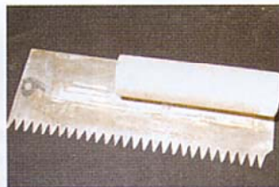
クシ目鏝 横方向に動かして櫛目を付ける。継目に気を付ける
